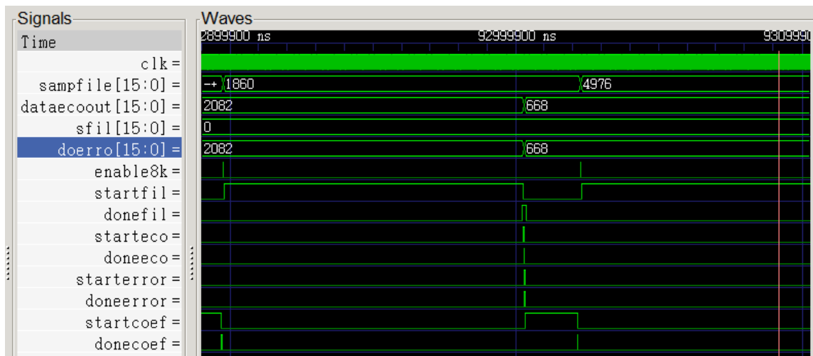
Figura 15 – Resultado de simulação (mista) do cancelador de eco utilizando SystemC.
